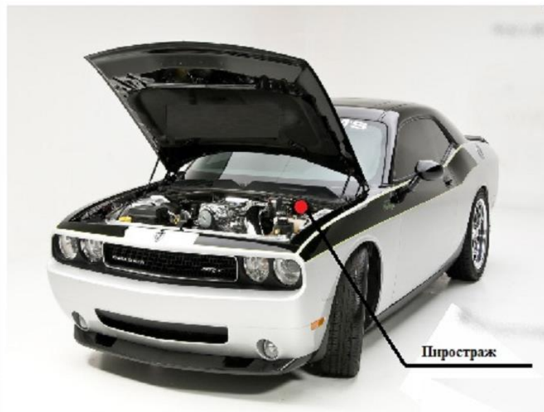
Рисунок 1. Схема монтажа ГОАП Пиростраж в моторном отсеке автомобиля
